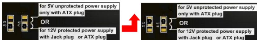
**ATTENTION : Le produit ne doit être alimenté que par une seule source, ne pas utiliser les 2 connecteurs d'alimentation à la fois.**
